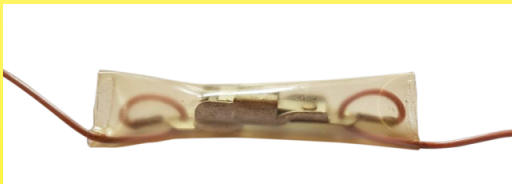
Calor ตัวจำกัดอุณหภูมิผ้าห่มทำความร้อน, เปรียบเทียบที่ 80°C (ประมาณปี 1960) สังเกตปลอกหุ้ม PVC กันน้ำที่เชื่อมติดกับลวดและห่วงที่ทำด้วยตัวนำไฟฟ้าที่ผ่านในแต่ละขั้ว - เพื่อขจัดความตึงที่เกิดจากแรงดึงบนลวด (แคตตาล็อก Ultimheat Collection)
