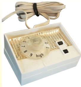
1970 การตั้งค่าพลังงาน GEC (General Electric อังกฤษ) บนผ้าห่มทำความร้อนของอังกฤษ ความต้านทานที่คาดไว้สามารถมองเห็นได้อย่างชัดเจนเหนือตัวเบรคชาโลหะคู่ (คอลเล็กชัน Ultimheat)
