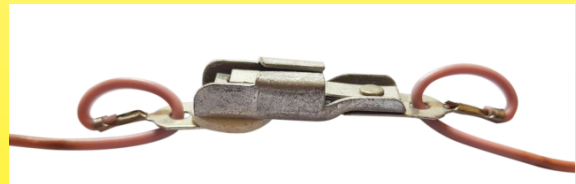
Calor ตัวจำกัดอุณหภูมิผ้าห่มทำความร้อน, เปรียบเทียบที่ 80°C (ประมาณปี 1960) สังเกตปลอกหุ้ม PVC กันน้ำที่เชื่อมติดกับลวดและห่วงที่ทำด้วยตัวนำไฟฟ้าที่ผ่านในแต่ละขั้ว - เพื่อขจัดความตึงที่เกิดจากแรงดึงบนลวด (แคตตาล็อก Ultimheat Collection)
