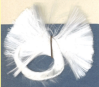
มัดใยแก้วรวมกันเป็นเส้นลวดเส้นเดี่ยว (การผลิตใยแก้วราวปี 1960, บทเรียนจากโรงเรียนสิ่งทอของ Verviers ในเบลเยียม, พิพีธร์กซ์ Ultimheat)
