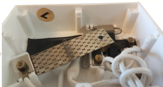
1970 การตั้งค่าพลังงาน GEC (General Electric อังกฤษ) บนผ้าห่มทำความร้อนของอังกฤษ ความต้านทานที่คาดไว้สามารถมองเห็นได้อย่างชัดเจนเหนือตัวเบรคชาโลหะคู่ (คอลเล็กชัน Ultimheat)
