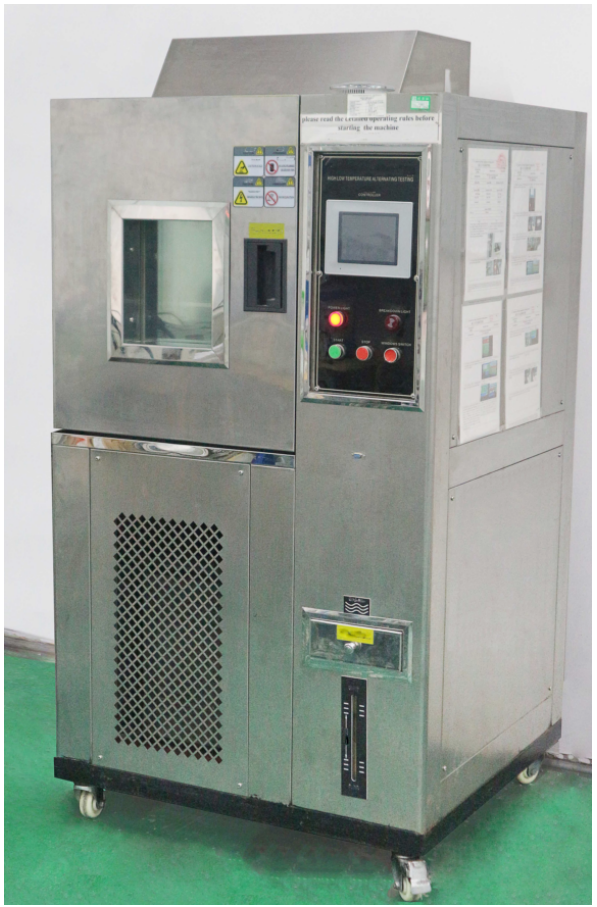
ตุ้ควมคุมอุณหภูมิที่มีช่วงการปรับอุณหภูมิตั้งแต่ -90 ถึง + 150°C และช่วงการปรับความชื้นสัมพัทธ์ 1 ถึง 100%
