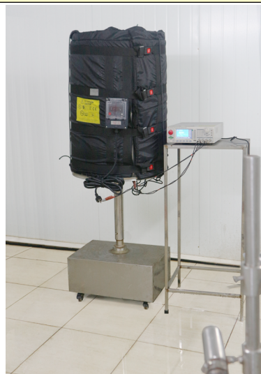
การวัดความต้านทานของฉนวนหลังการทดสอบ IPx6
