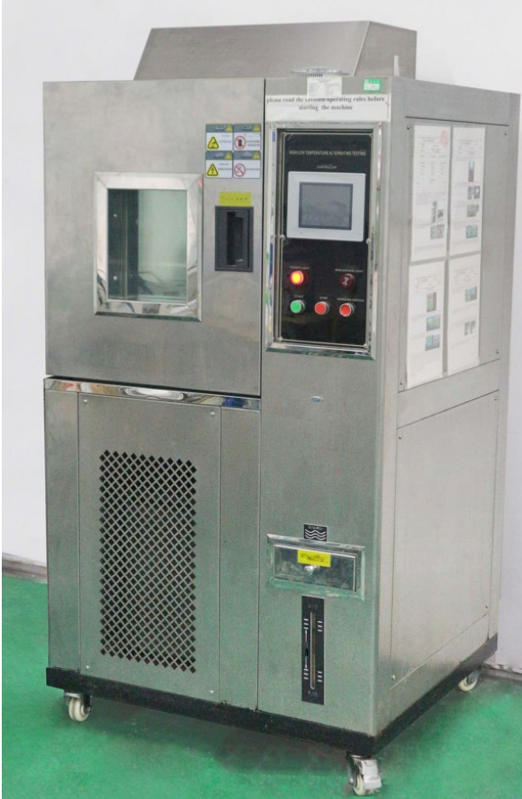
ดูควบคุมอุณหภูมิที่มีช่วงการปรับอุณหภูมิตั้งแต่ -90 ถึง + 150°C และช่วงการปรับความชื้นสัมพัทธ์ 1 ถึง 100%
