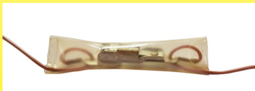
Calor ตัวจำกัดอุณหภูมิผ้าห่มทำความร้อน, ปรับเทียบที่ 80°C (ประมาณปี 1960) สังเกตปลอกหุ้ม PVC กันน้ำที่เชื่อมติดกับลวดและห่วงที่ทำด้วยตัวนำไฟฟ้าที่ผ่านรูในแต่ละขั้ว - เพื่อขจัดความตึงที่เกิดจากแรงดึงบนลวด (แคตตาล็อก Ultimheat Collection)
