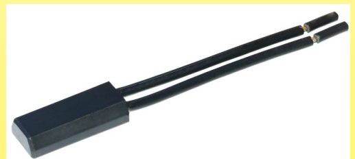
2019 ตัวจำกัดอุณหภูมิแบบสแนปปิดสำหรับหม้อแปลงทำความร้อนซึ่งได้มาจากรุ่น 1966 ของ Texas Instruments 7AM ใช้งานได้ที่ 230 โวลต์ ในปลอกพลาสติกกันน้ำ ช่วงอุณหภูมิ 5 ถึง 8°C ประเภท V7AM (คอลเล็กชัน Ultimheat)
