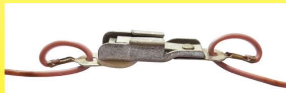
Calor ตัวจำกัดอุณหภูมิผ้าห่มทำความร้อน, ปรับเทียบที่ 80°C (ประมาณปี 1960) สังเกตปลอกหุ้ม PVC กันน้ำที่เชื่อมติดกับลวดและห่วงที่ทำด้วยตัวนำไฟฟ้าที่ผ่านรูในแต่ละขั้ว - เพื่อขจัดความตึงที่เกิดจากแรงดึงบนลวด (แคตตาล็อก Ultimheat Collection)
