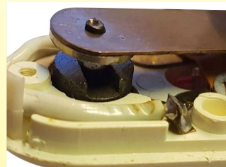
1972 กล้องควบคุมพลังงานทำโดย Jidé ใน Limoges ภายใต้แบรนด์ Jidéstat ประสบความสำเร็จสูงสุดจากทุกระบบ ขนาดที่เล็กมาก สามารถปรับได้และรวมอยู่ในปลั๊กไฟฟ้า นี่เป็นรุ่นเดียวที่มีหน้าสัมผัสแม่เหล็กแบบสแนป มันไม่ได้ถูกแทนที่โดยระบบเครื่องกลไฟฟ้าจนกระทั่งยุคปัจจุบัน (คอลเล็กชัน Ultimheat)
