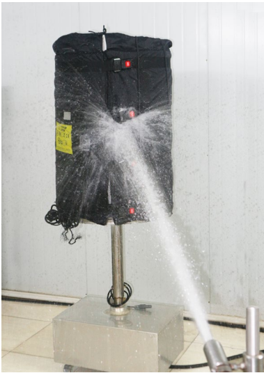
การทดสอบ IPx6 ของเครื่องทำความร้อนแบบแจ็คเก็ต
