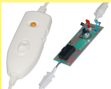
หน่วยควบคุมผ้าห่มที่ควบคุมพลังงานด้วยอิเล็กทรอนิกส์อย่างต่อเนื่อง 2019 ) (คอลเล็กชัน Ultimheat)
