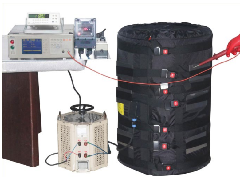
เครื่องมือวัดสำหรับการรั่วไหลของกระแสรวมที่สภาวะร้อน
