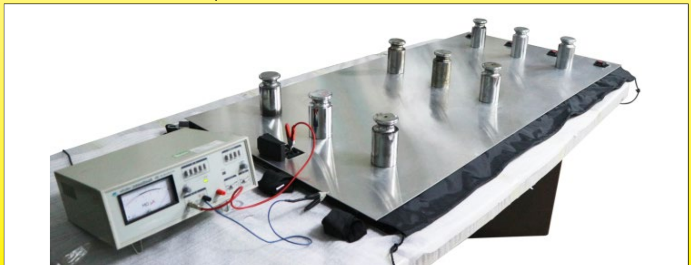
อุปกรณ์สำหรับวัดความต้านทานของฉนวน ค่าที่วัดได้จะมากกว่า 0.1 กิโลโห์ม เสมอ
