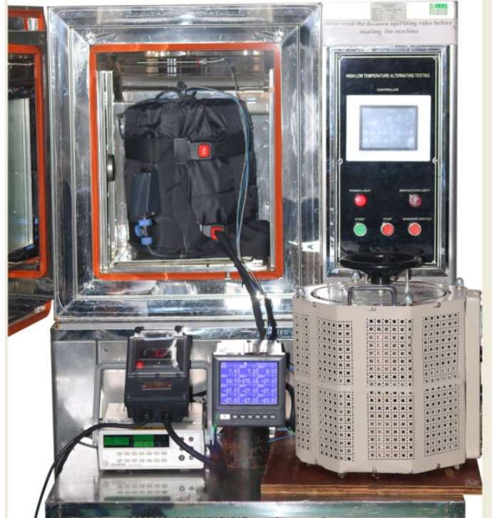
เครื่องทำความร้อนแบบแอคทีฟเกิดในระหว่างการทดสอบสภาพภูมิอากาศในอุณหภูมิลบ
