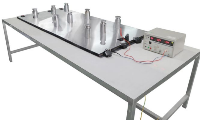
เครื่องมือวัดสำหรับการรั่วไหลของกระแสรวมในสภาวะเย็น
