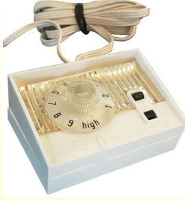
1970 การตั้งค่าพลังงาน GEC (General Electric อังกฤษ) บนผ้าห่มทำความร้อนของอังกฤษ ความต้านทานที่คาดไว้สามารถมองเห็นได้อย่างชัดเจนเหนือตัวเบรคชาโลหะคู่ (คอลเล็กชัน Ultimheat)
