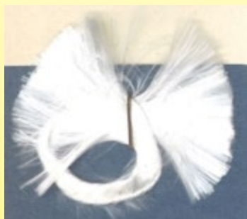
มัดใยแก้วรวมกันเป็นเส้นลวดเส้นเดียว (การผลิตใยแก้วราวปี 1960, บทเรียนจากโรงเรียนสิ่งทอของ Verviers ในเบลเยียม, พิพิธภัณฑ์ Ultimheat)
